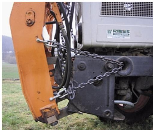
Wer solch einen Frontlader dauerhaft an nur einem Schlepper einsetzt, sollte die Ketten durch Streben ersetzen.
