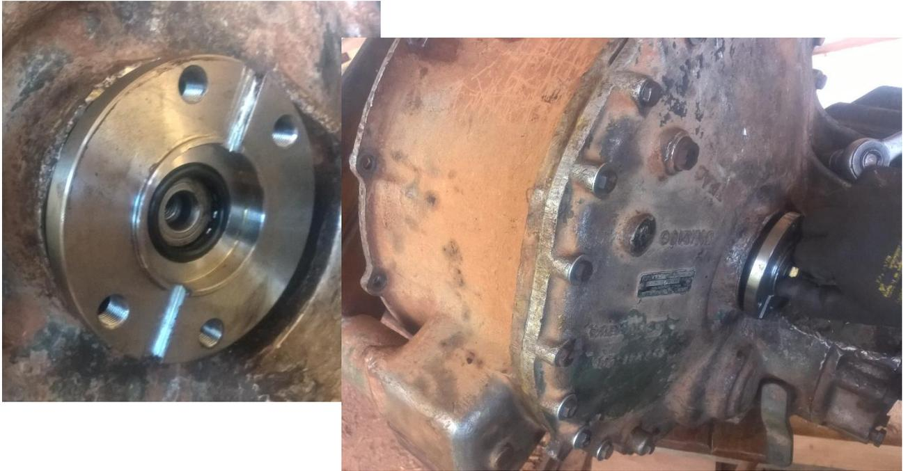
Was wissen die Mercedesingenieure schon über den MB-Trac?! Baut man die Druckplatte der Kupplung halb auseinander, passt das Zwischengetriebe auch ohne Motorausbau oder Absenkung in den Trac.
