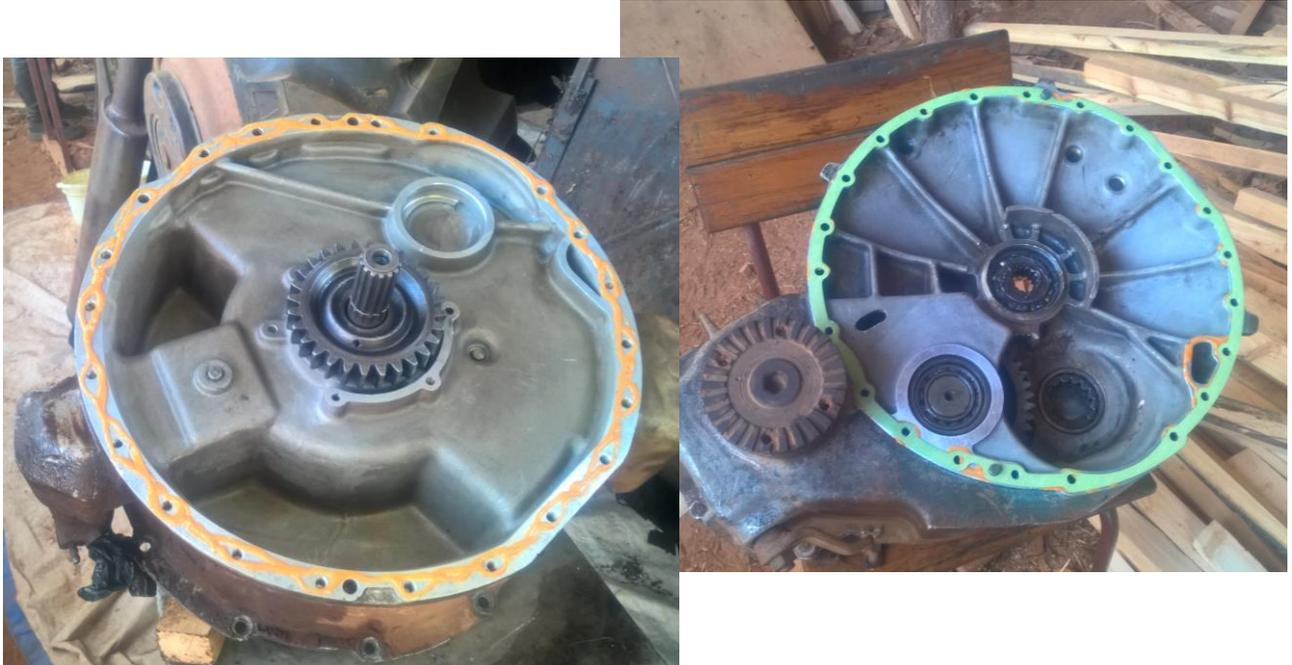
Dann wurde der äußere Simmering in mit Spezialwerkzeug A251 000000001 vorsichtig in das Gehäuse gepresst:
