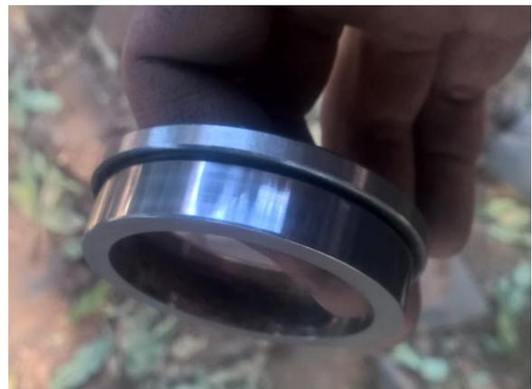
Der Ring gegen den das Lager Lauft musste komplett neu gefertigt werden. Nach einiger Suche fand sich eine alte Halslagerschale eines Toyota Differentials, die in etwa den gewunschten Dimensionen entsprach.
