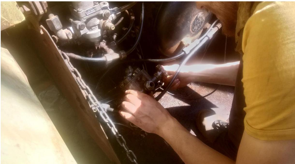
Hier wäre noch zu erwähnen, dass der hydraulische Teil der Bremsanlage seit Jahren außer Betrieb ist. Der Grund ist unklar. Gebremst wird mit dem Motor oder der druckluftbetriebenen (dosierbaren!) Feststellbremse.
