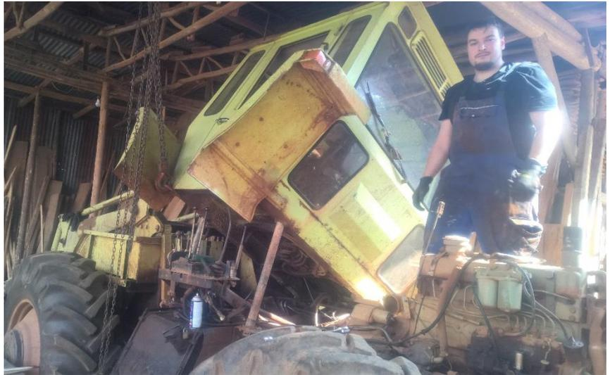
Die Werkstattbücher und Werkzeuge wurden bereit gelegt und anschließend die Kabine, mit einem an der überaus stabilen Holzkonstruktion angebrachten Seilzug, gekippt.
