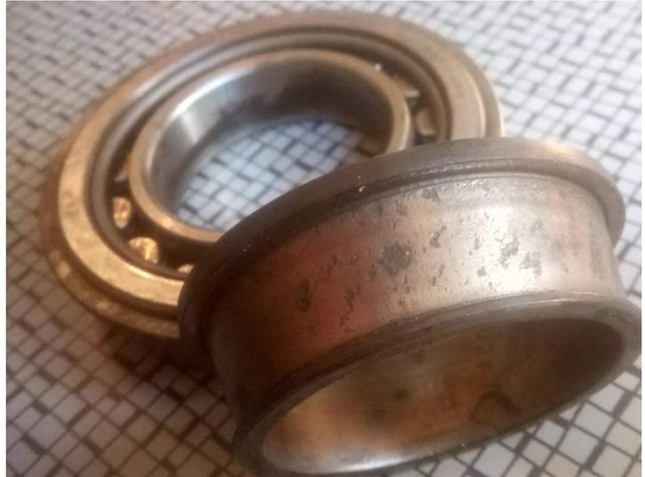
Der gewunschte Ring wurde vorsichtig mit dem Trennschleifer von der Schale getrennt und am Schleifbock unter standiger Kuhlung passend geschliffen. Das letzte Zehntel wurde auch hier mit Sandpapier und einem 1500er Schleifstein heruntergeschliffen.
