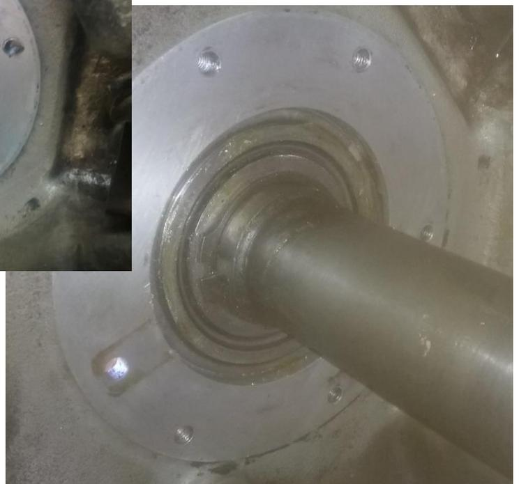
Dann fiel auf, dass der Simmering der Hohlwelle gegen das Kupplungsgehäuse abdichtet, ja auch praktisch nicht mehr existent war. Nach langer Teilesuche wurde ein Toyotasimmering zurecht gearbeitet und eingepasst.
