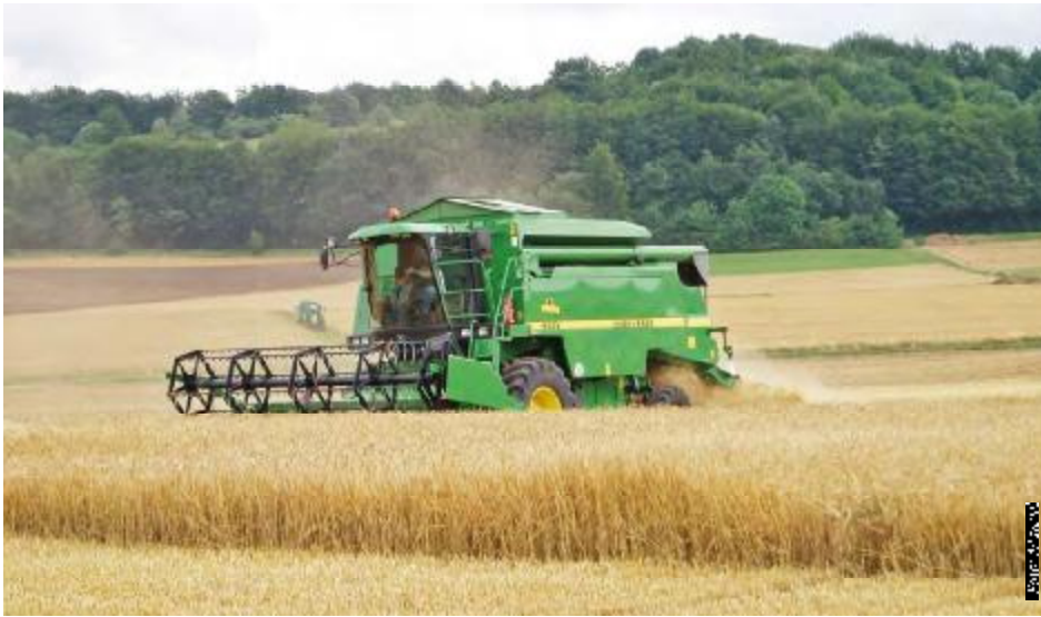
Das Schneidwerk eine Nummer kleiner ermöglicht eine optimale Strohverteilung.
