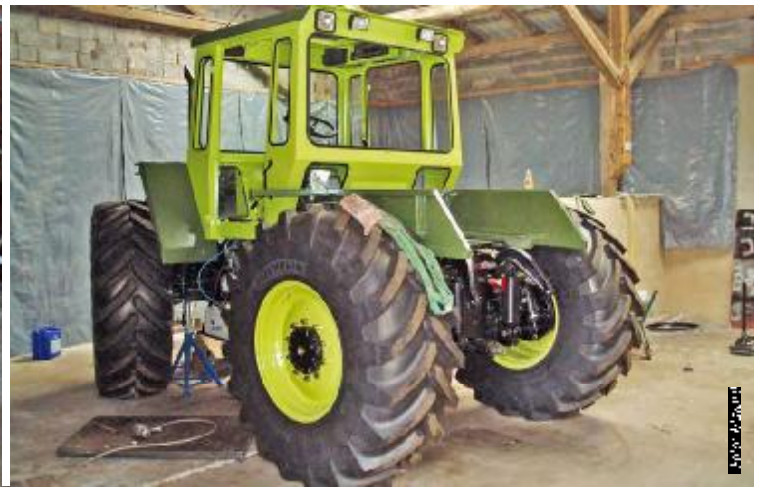
Der MB Trac, vom Landwirt selbst komplett zerlegt, überholt und neu gespritzt, präsentiert sich als neuwertiger Schlepper.
